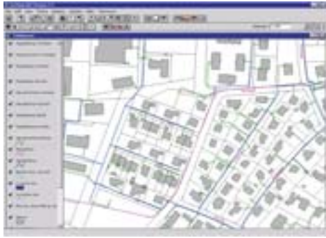
Ausschnitt mit Ring-, Haupt- und Hausanschlussleitungen
